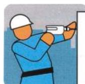
Faça um furo com broca de  $\varnothing$  igual ao  $\varnothing$  externo do chumbador até a profundidade indicada.
